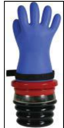
G100 avec gant basse tension gonflé et prêt Pour inspection / G100 with inflated low-voltage glove ready for inspection
